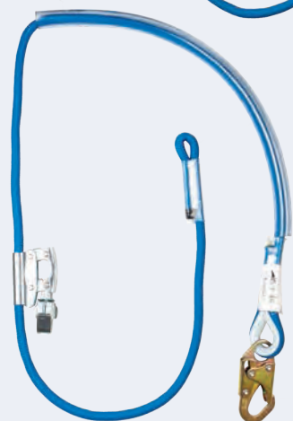
B2KTC • Cable de posicionamiento • STD (1.08 - 2.30) • Cinta Kermantle perlón • Gancho estampado tropicalizado • Sujetador de acero • Recubrimiento anti roce • Gancho ANSI
