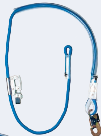
B2KT • Cable de posicionamiento • STD (1.08 - 2.30) • Cinta Kermantle perlón • Gancho estampado tropicalizado • Con sujetador de acero • Recubrimiento anti roce • Gancho EN
